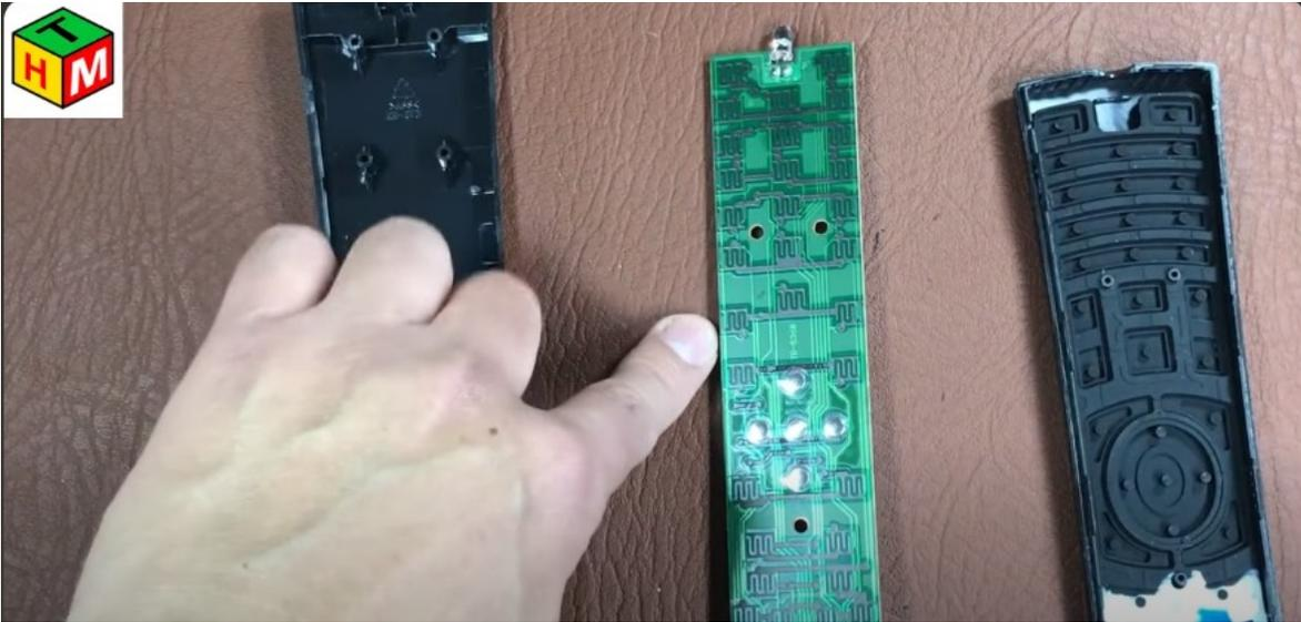
Entonces cómo lo vamos a solventar o solucionar bueno de una manera muy fácil y simple que va a ser con papel aluminio
