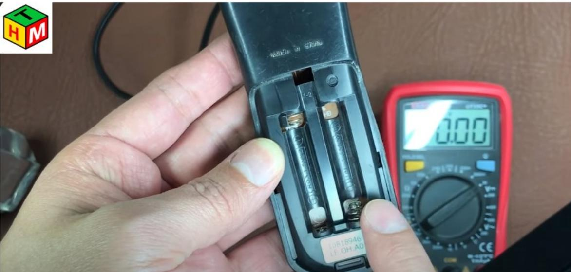
aquí es el negativo y aquí es el positivo si se confunden tampoco les va a funcionar, entonces vamos a colocarlo y lo probamos
