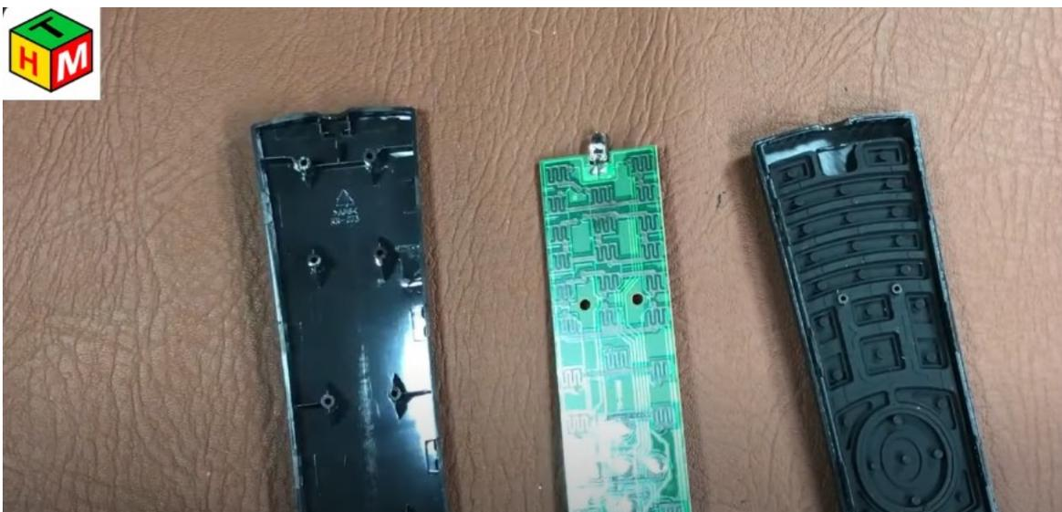
allí podemos ver el control desarmado completamente y en este caso no nos vamos a enfocar ni en el LED ni en todos los contactos, ni vamos a limpiar nada de hecho este control está bastante nuevo, digamos así, pero sí que se ha usado bastante las teclas del volumen
