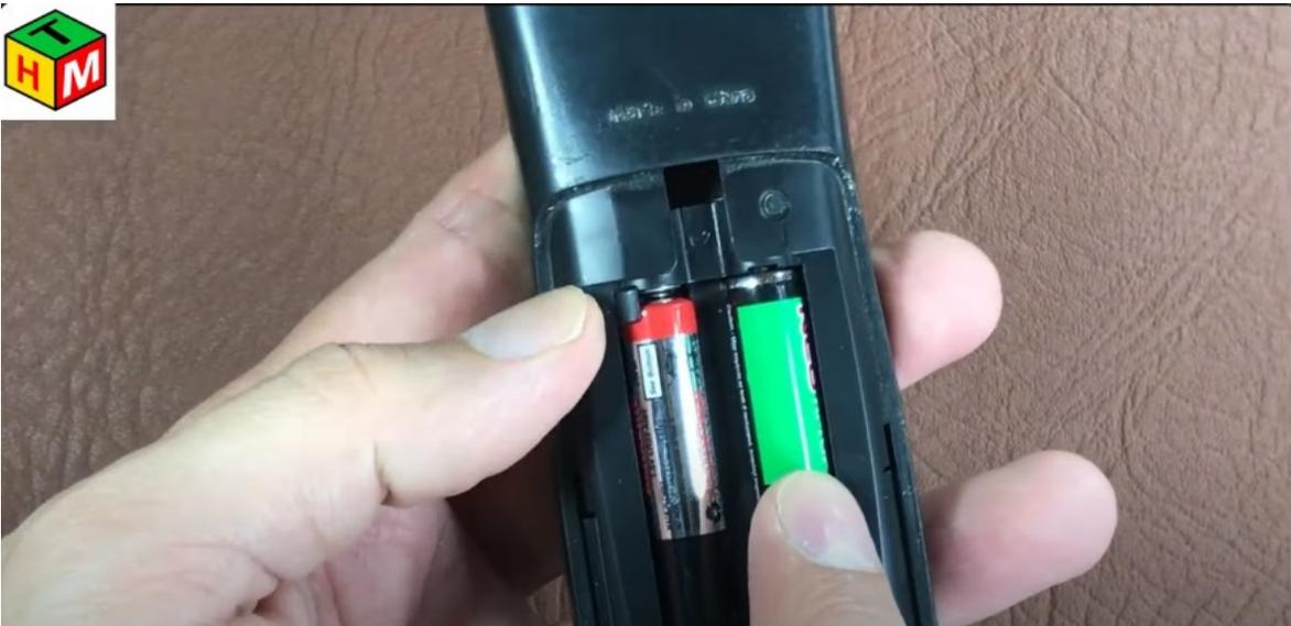
o sea tienen que estar haciendo buen contacto en estos puntos y, luego de hacer esa verificación, de que las pilas estén buenas y que igualmente no funcione. Entonces vamos a proceder a desarmarlo completamente y vamos a aprovechar en este control para explicar todas las posibles fallas que puede presentar un control remoto o un mando a distancia.
