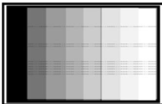
6. Defecto de línea horizontal (siempre brillante u oscura) (ver la Fig. 6.22). Modo de falla **H L/D**.
