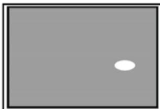
3. El polarizador tiene una marca o rayadura (ver la Fig. 6.31). Generalmente se debe a la acción de una herramienta dura o punzante
