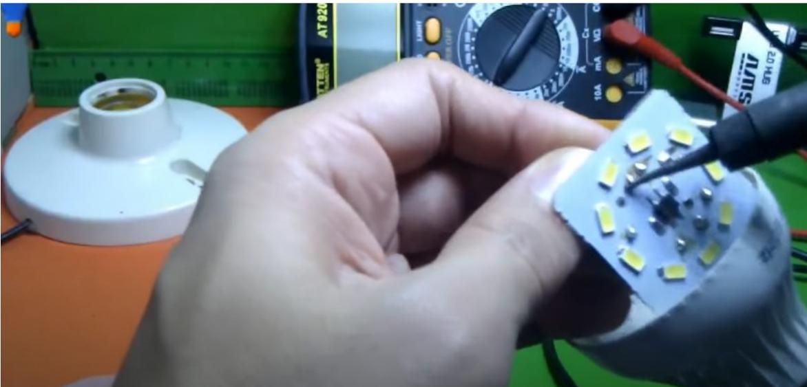
Al sustituirlo si consiguen un capacitor del mismo valor y más voltaje, este es de 50 y se va a cambiar por uno de 63 voltios, es recomendable ponerle uno de un poco más de voltaje
