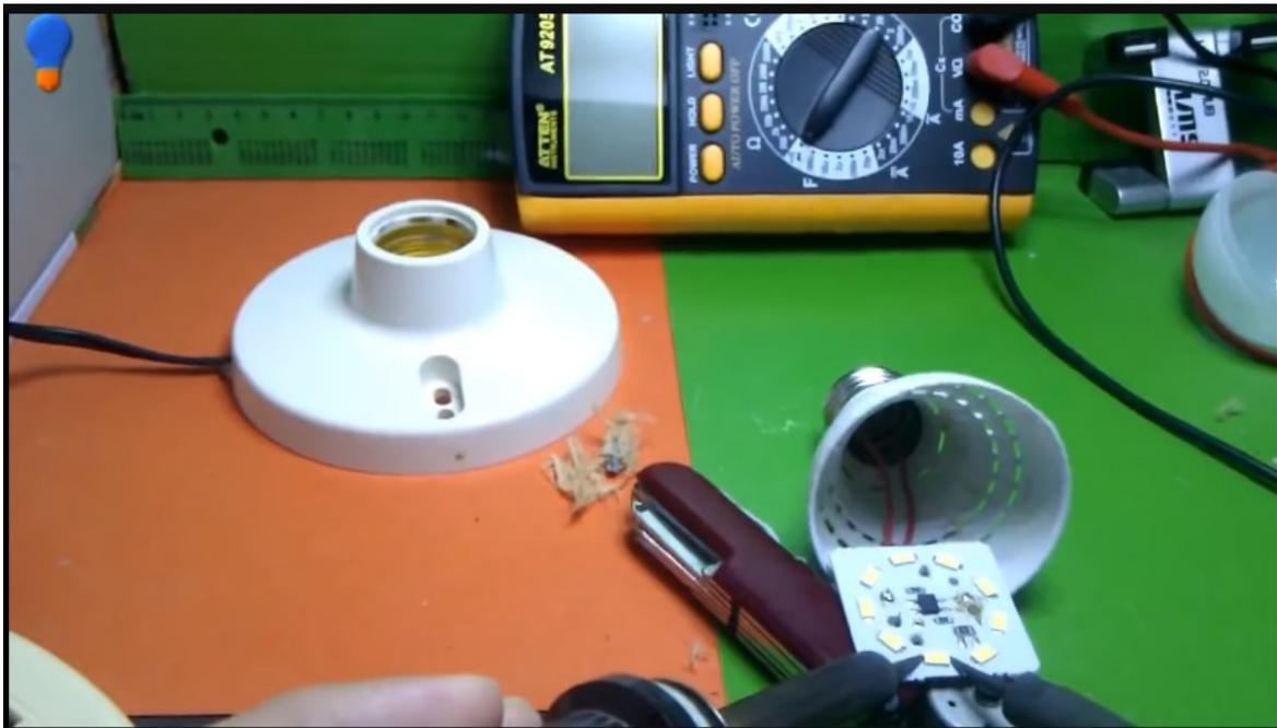
Este es el Led que tiene el problema. el Led que se va a colocar simplemente se coloca en la misma posición.
