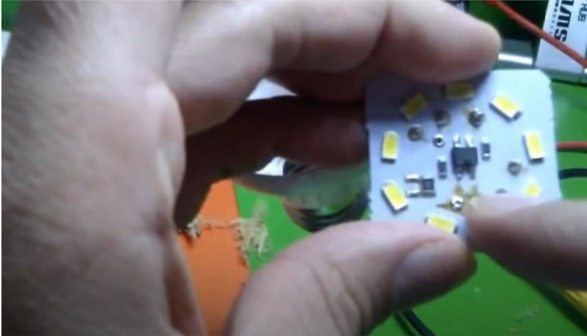
Se instala y se ya se puede soldar el capacitor, se cortan los excedentes de las patas.
