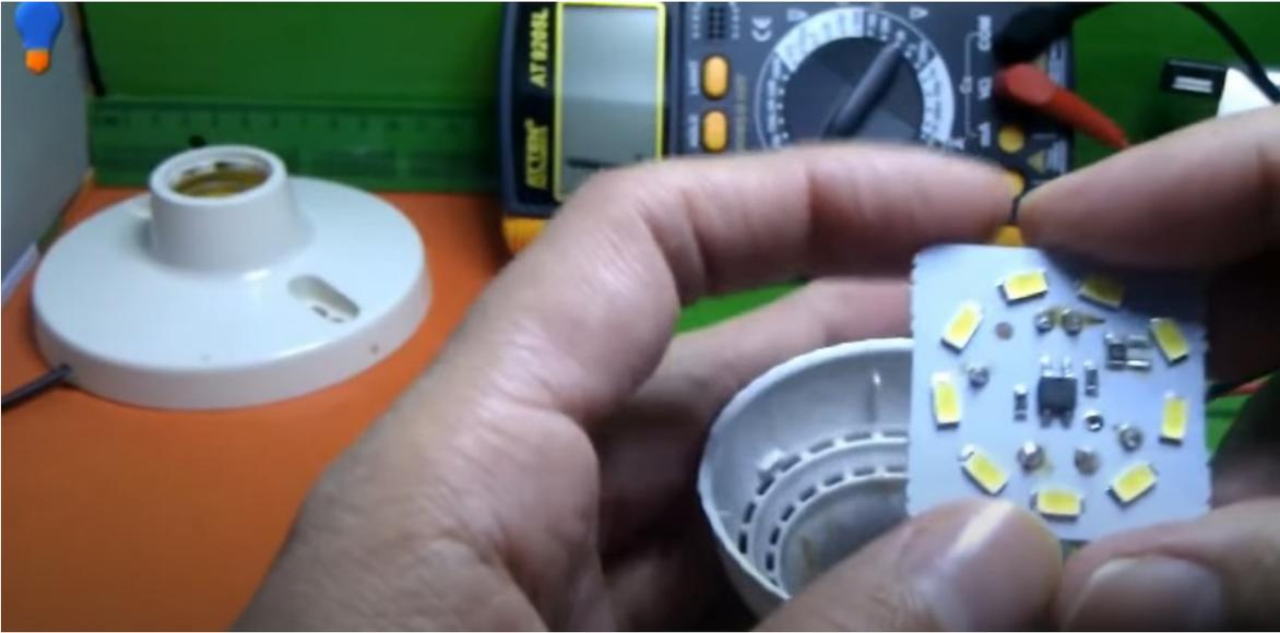
Se debe desoldar lo que quedo del capacitor dañado y soldar otro.
