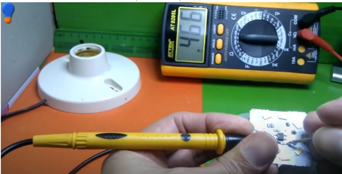
Solo queda medir el puente rectificador, es muy fácil, aquí se tiene el negativo y el positivo, del negativo salen dos diodos igual del positivo, según el diagrama como pueden observar. La diferencia es que los que llegan al positivo están invertidos con los que llegan al negativo. Se cambia el tester a Diodo y se mide la polarización de ambos diodos,
