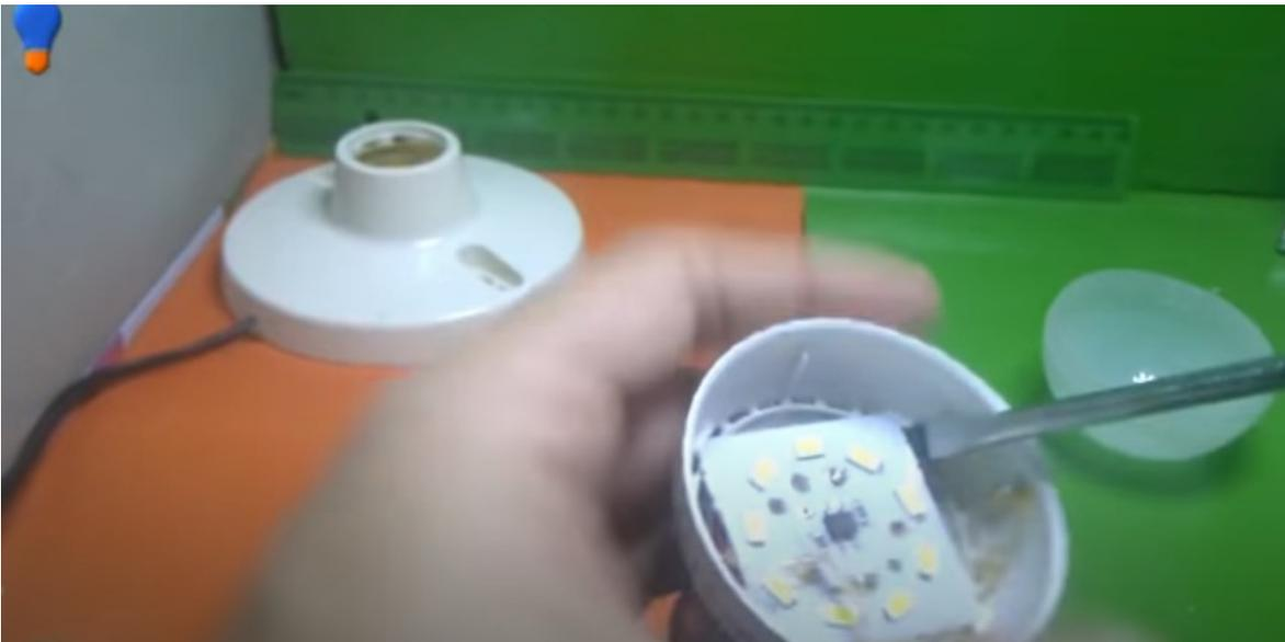
Bueno observen que paso, se estalló el capacitor electrolítico, solo tiene un solo capacitor, en este caso esta lámpara es de fuente capacitiva, estas son muy propensas a que pasen estos casos
