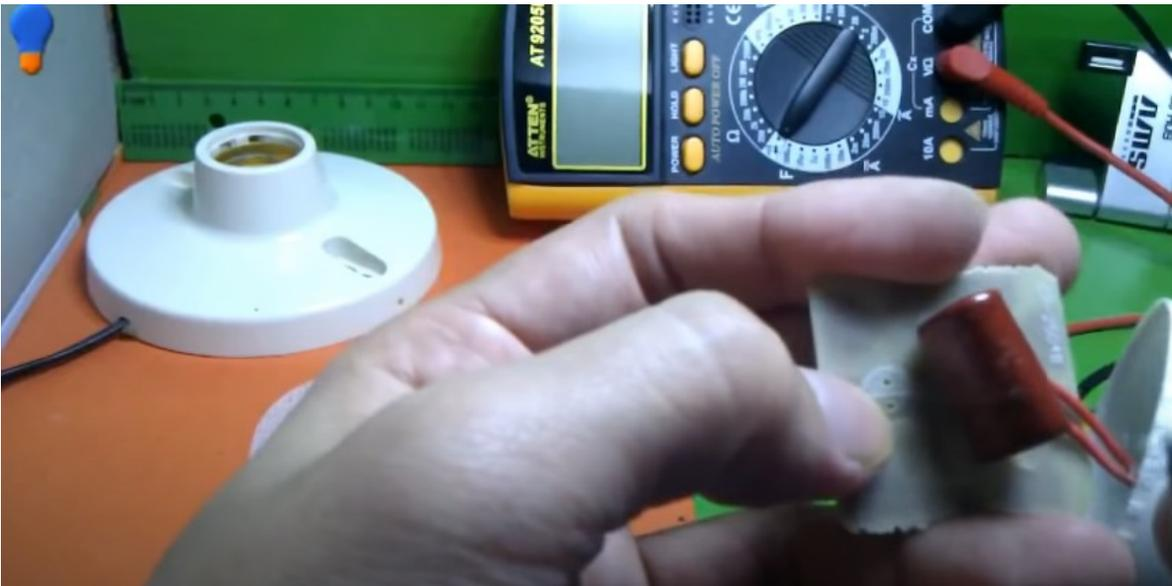
Simplemente se sigue la pista, y se ve el que llegue al negativo, un pin del capacitor va llegar al negativo del puente y otro pin del capacitor va llegar al positivo del puente, es muy fácil de ubicar, pero aquí también lo muestra el diagrama que tiene dibujado acá.
