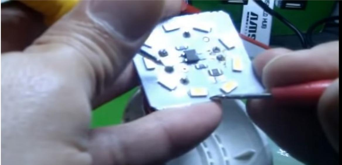
Se debe desoldar el Led quemado, aplicando la técnica de trabajar con dos cautines desoldando componentes de montaje superficial, en este caso los Led cuesta más porque ellos tienen una placa de metal que disipa el calor y cuesta más soldar.
