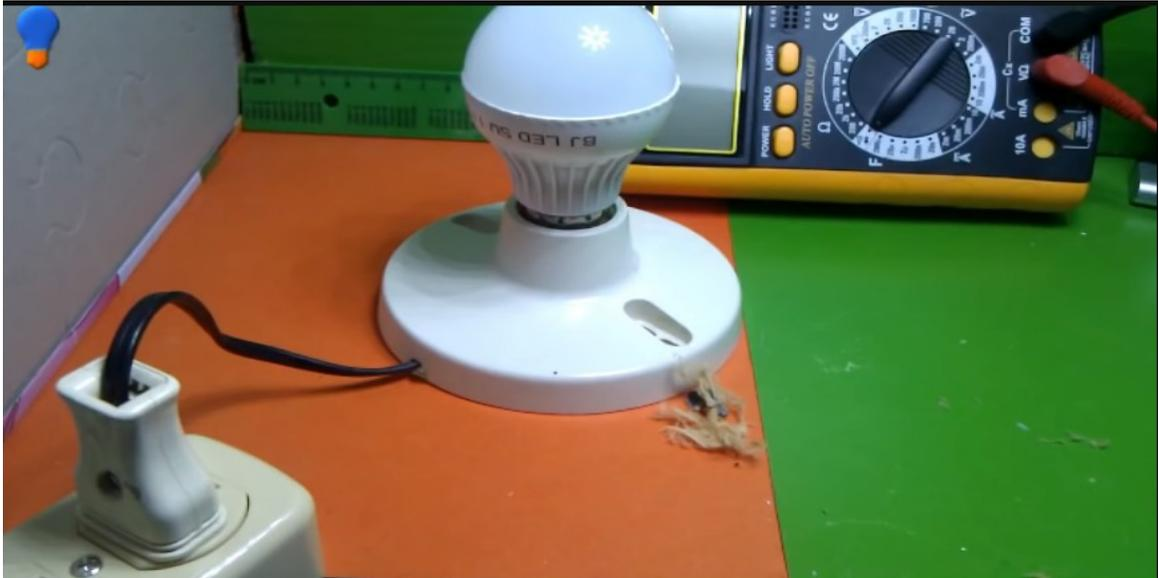
En el diagrama pueden ver que sigue para adelante dos resistencias y los Led, se debe probar que los Led estén buenos, podría que un Led este dañado y como están en serie si uno está dañado tampoco va a prender.
