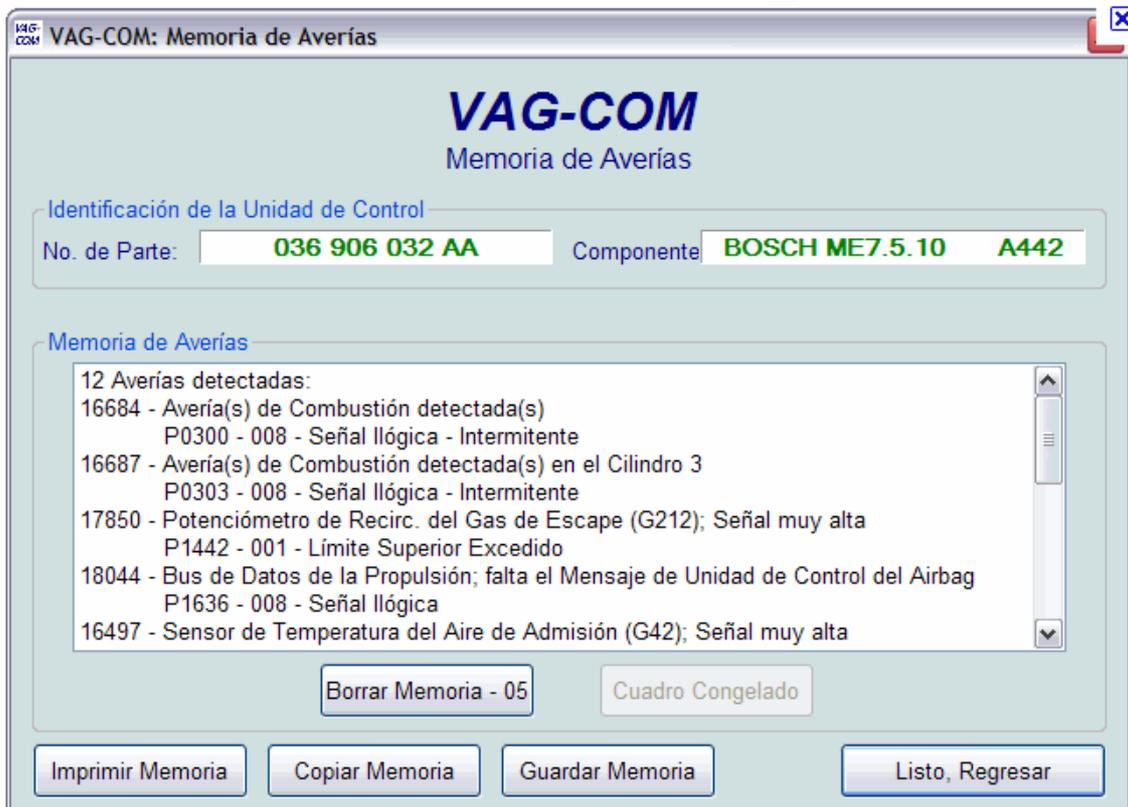
Si la ecu logra comunicarse con el VAG-COM quiere decir que el micro-procesador esta funcionando perfectamente, en caso que pueda comunicarse entonces esta dañado. Una computadora con el micro-procesador dañado es muy difícil de reparar ya que esta pieza es diseñada por el fabricante a la medida lo que hace imposible buscar un reemplazo.
