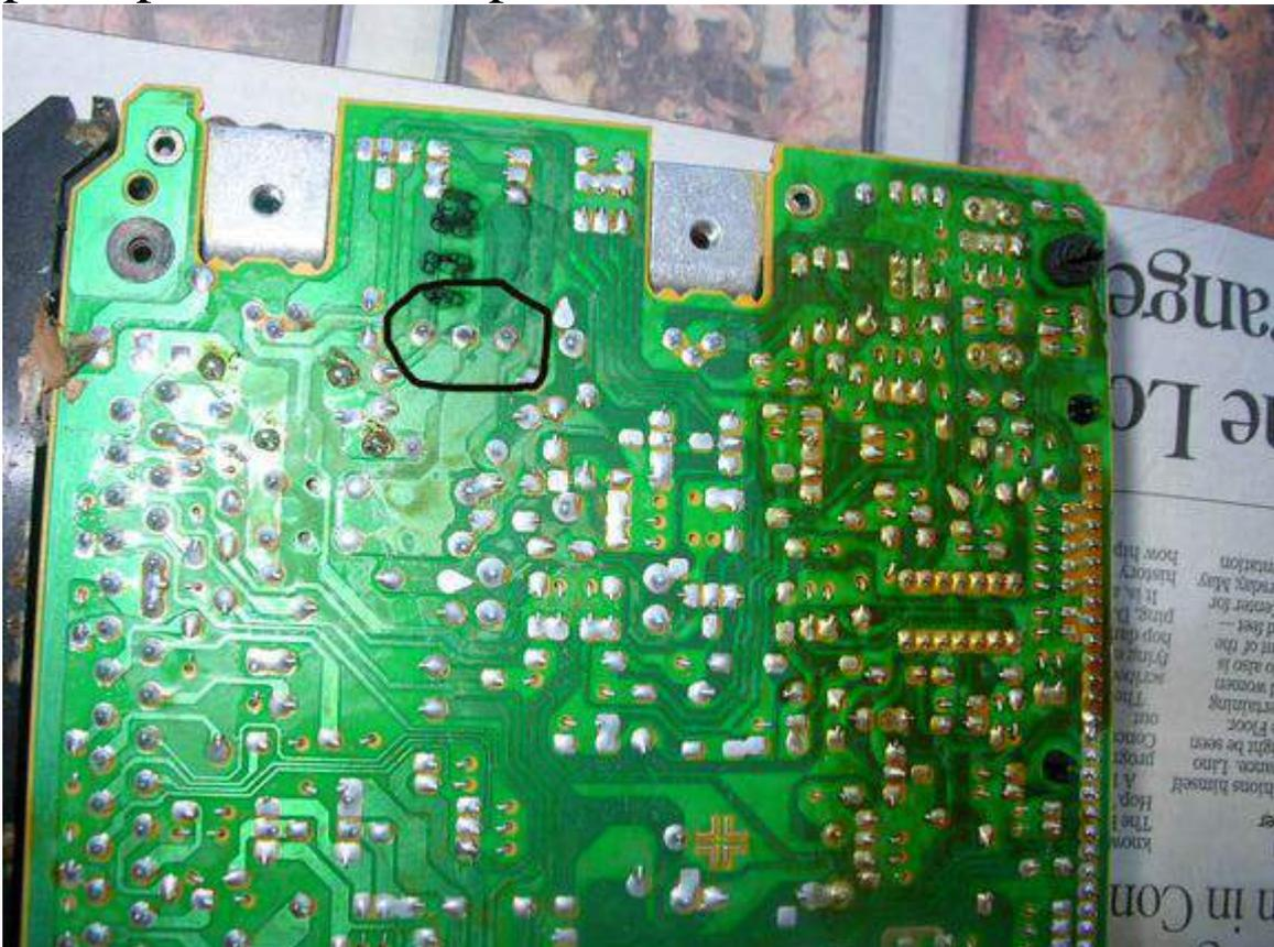
los tres puntos de soldadura están agrietados. Puede no parecer mucho, pero este tipo de anomalía causa la pérdida momentánea de la conexión. la corrosión se acumulan en estas grietas. Para verificar si una ecu presenta este tipo de fallas necesariamente se debe de realizar una inspeccion visual.
